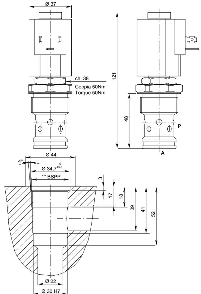
**Valvola elettrica 2 vie unidirezionale pilotata con o senza vite di emergenza**
