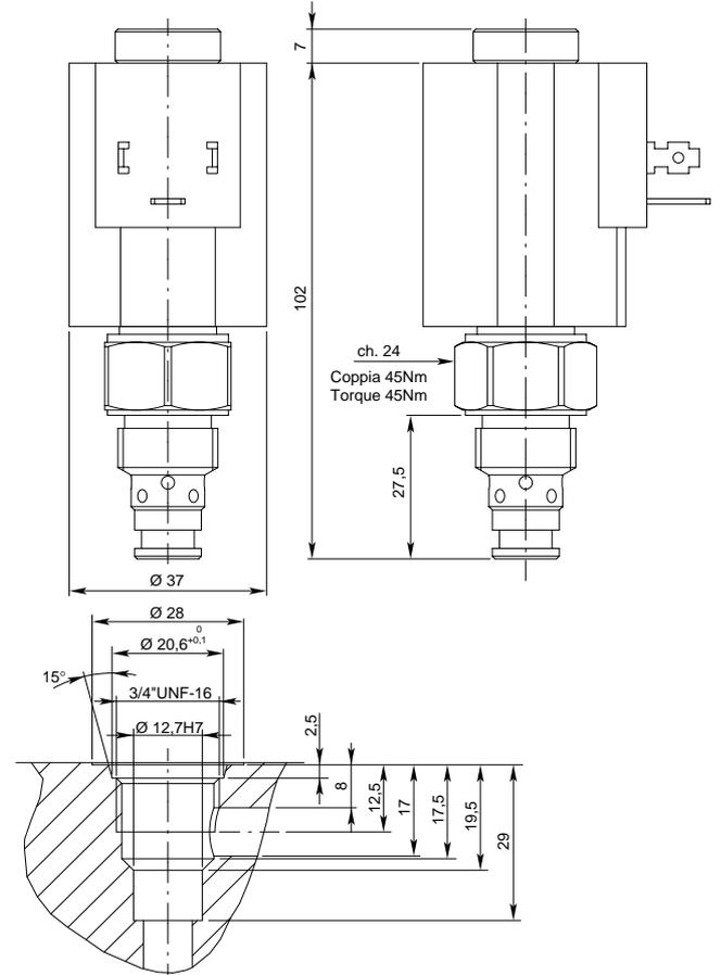
**Válvula eléctrica 2 vías unidireccional pilotada con o sin accionamiento de emergencia**
